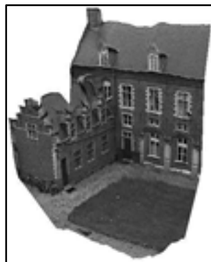
Figura 16: resultado da triangulação e texturização da reconstrução densa obtida na Figura 15 [5]
