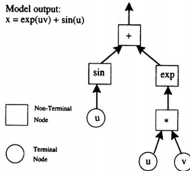
Estrutura do cromossomo para a seleção de uma estrutura de modelo adequado
