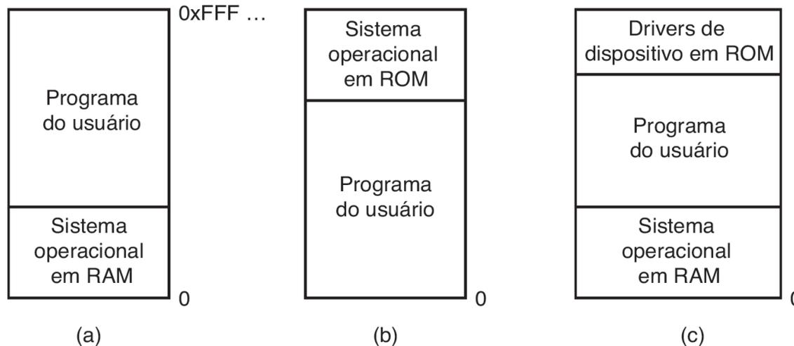
**Figura 3.1** Três modos simples de organizar a memória com um sistema operacional e um processo de usuário. Também existem outras possibilidades.
