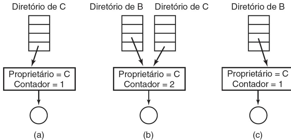
**Figura 4.15** (a) Situação antes da ligação. (b) Depois da criação da ligação. (c) Depois que o proprietário original remove o arquivo.
