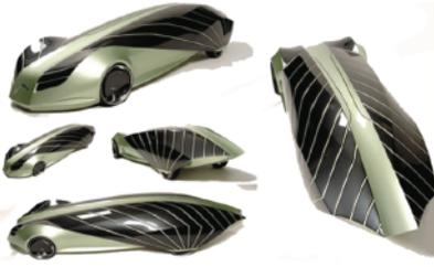
Conceito de carro movido a energia solar. Quando estacionado, seus painéis se voltam ao sol para melhor captação de luz, tal qual um girassol.
