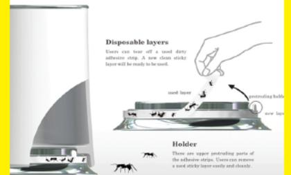
A base é de forma curva e com uma fita aderente, que impede que as formigas andem pelo lixeiro e as deixam grudadas na fita.
