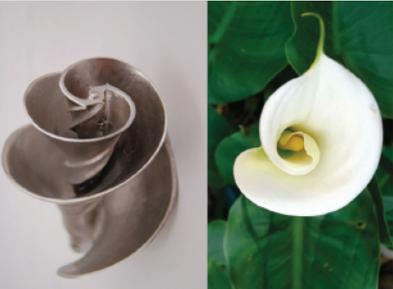
Misturador de líquidos que usa uma lâmina baseada no formato de lírio para minimizar o gasto de energia.
