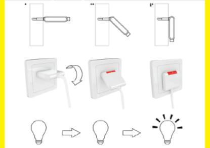
Tomada-interruptor inteligente que pode ser ligado ou desligado ao ser dobrado ou desdoblado em relação à parede.
