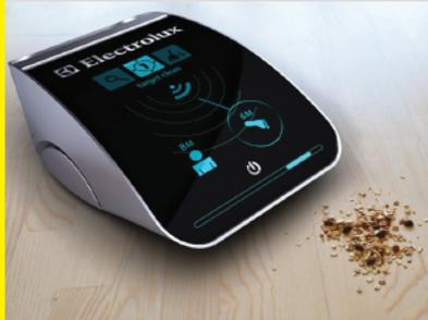
Robô faxineiro que é guiado através de um controle fixado no chinelo do usuário. Dois pisões para limpar/cancelar e três para retornar ao seu canto.
