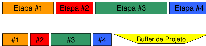
Figura 3.12. Utilização de um buffer de projeto no final do caminho crítico (extraído de [Goldratt 1998]).
