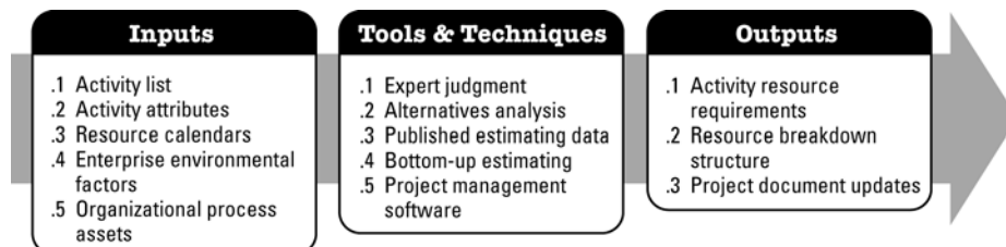
Figura 6-8. Estimar os recursos da atividade: entradas, ferramentas e técnicas e saídas
