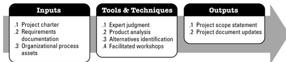
Figura 5-4. Definir o escopo: entradas, ferramentas e técnicas, e saídas
