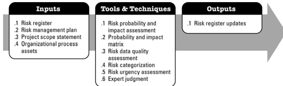
Figura 11-8. Realizar a análise qualitativa de riscos: entradas, ferramentas e técnicas, e saídas
