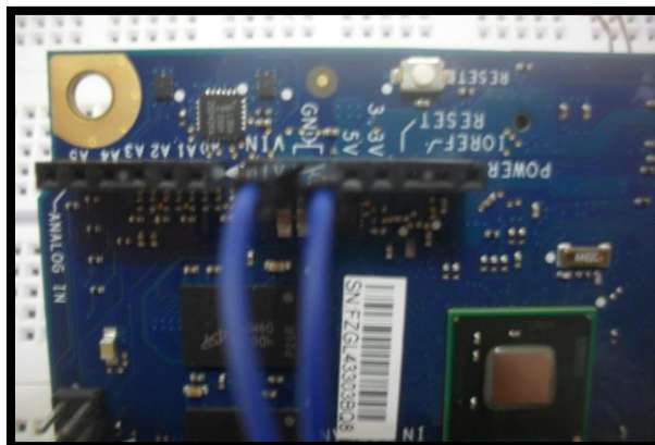
Figura 13 – Dois fios de conexão ligados ao GND (terra) do Galileo
