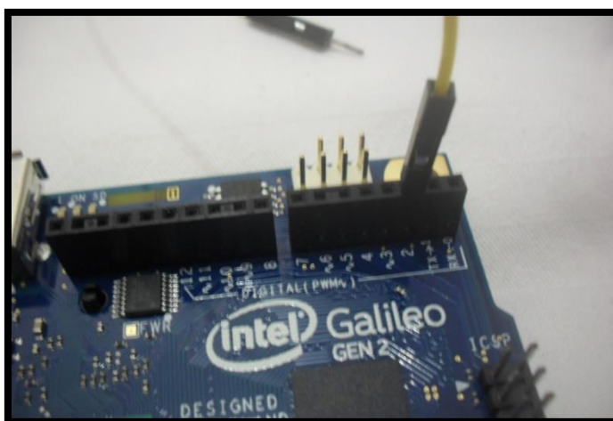
Figura 17 – Ligação do fio amarelo ao pino digital 2 do Galileo
