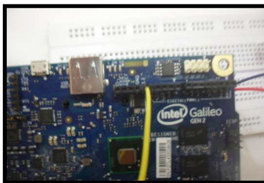
Figura 9 – Conectando o fio ao pino 13 do Galileo
