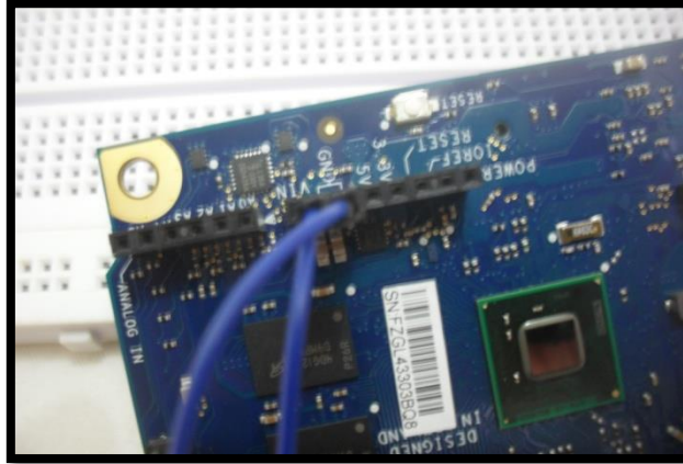
Figura 5 – Conectando os fios ao pino GND do Galileo
