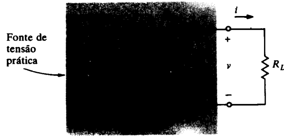
FIGURA 5.23 Fonte de tensão prática conectada a uma carga R_L
