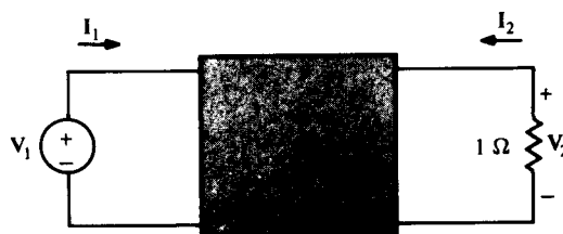
FIGURA 14.16 Quadripolo carregado com um resistor de 1\text{-}\Omega
