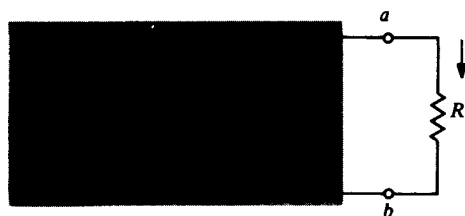
FIGURA 5.17 Equivalente de Norton do circuito da Fig. 5.14, com carga
