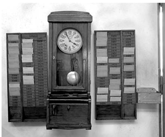
Figura 11.3: Este é um relógio de ponto, um modelo antigo de controle dos horários. Cada funcionário possuía um cartão que era inserido na parte frontal do relógio e este marcava a hora exata da chegada e saída. Hoje este modelo foi superado e o controle das horas geralmente é feito eletronicamente (por computadores).
