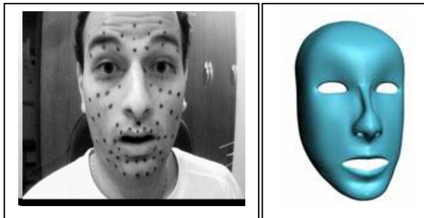
Figura 1: Expressão facial obtida através do processo de motion capture baseado em aquisição estereoscópica utilizando duas câmeras.
