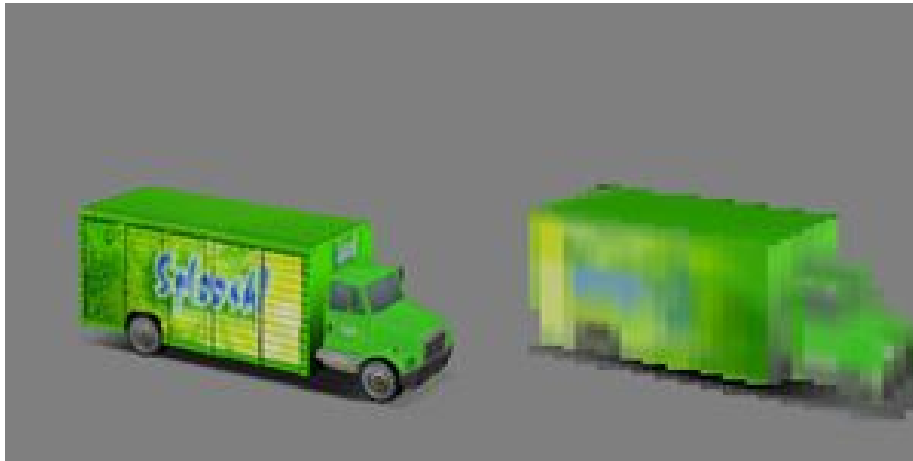
Figura 12 - Modelo real (Esquerda) e o Imposter [6] criado(Direita)
